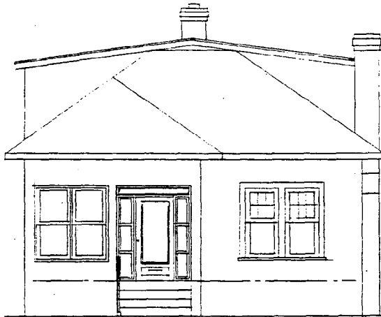
FRONT ELEVATION SCALE: 1/8" = 1'-0"
