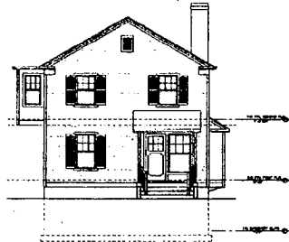
1 EXISTING FRONT ELEVATION SCALE: 1/8" = 1'-0"
