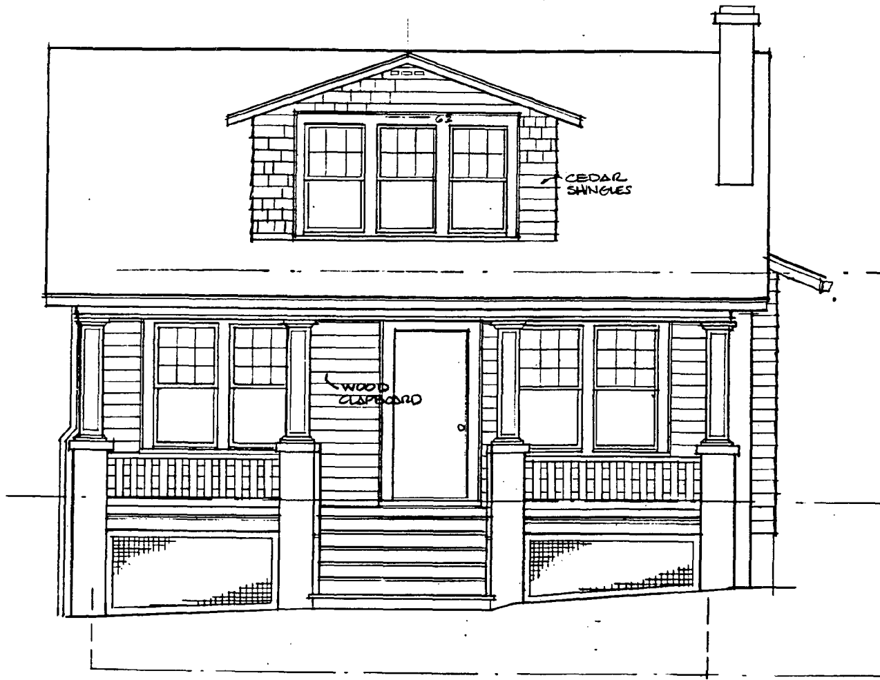
EXISTING FRONT (N.E.) ELEVATION
